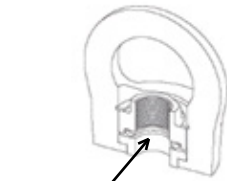
Sistema autobloccante integrato Integrated self locking system Système autobloquant intégré Integrierte Selbstsicherung
